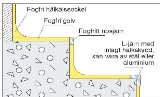
Bild 5: Beläggning av trappa. "Fri kant" förses med rostfritt/aluminium nosjärn 50-70 x 5 mm alt. L-järn/-profil.
